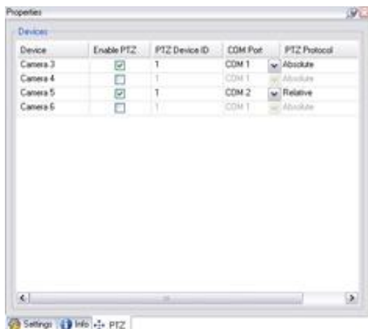
Onglet PTZ, avec activation PTZ pour deux canaux d'un encodeur vidéo
