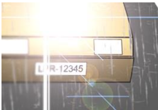
Image d'une plaque d'immatriculation présentant des traces du fait d'une surexposition
